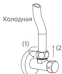
б. Наденьте гайку трехходового шарового крана на полиэтиленовую трубу 3/8" (9,525 мм) и вставьте трубу в отверстие трехходового шарового крана. Затяните гайку гаечным ключом.
