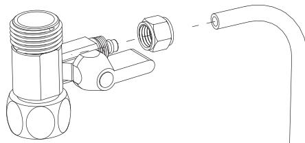
c. Zainstaluj trójdrożny zawór kulowy na zaworze zimnej wody. Podczas instalacji nie zapomnij o uszczelce wewnętrznej trójdrożnego zaworu kulowego.
