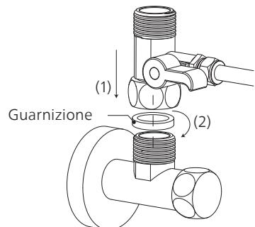
d. Connettere il tubo dell'acqua fredda con la valvola a sfera a tre vie e avvitare serrando con una chiave. Non dimenticare la guarnizione nel tubo dell'acqua fredda durante l'installazione.
