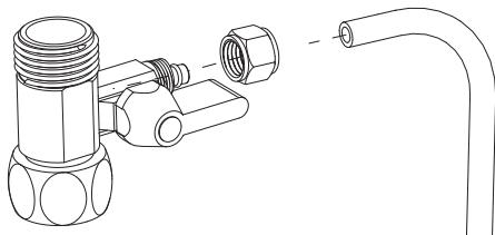
c. Instale la válvula de bola de tres vías en la válvula de agua fría. No se olvide de la junta dentro de la válvula de bola de tres vías durante la instalación.
