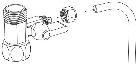
c. Installer le robinet à boisseau sphérique à trois voies sur le robinet d'eau froide. Ne pas oublier le joint situé à l'intérieur du robinet à boisseau sphérique à trois voies au cours du montage.
