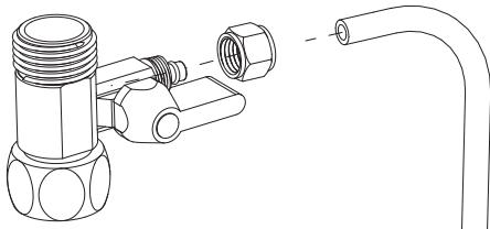
с. Установите трехходовой шаровой кран на смеситель холодной воды. Пожалуйста, во время установки не забудьте про уплотняющую прокладку внутри трехходового шарового крана.
