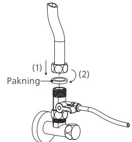
e. Sluk for trevejskugleventilen. Tænd for koldtvandsforsyningen. Tør forbindelserne af med en serviet for at se, om der er lækkage. Hvis servietten forbliver tør, betyder det, at trevejskugleventilen er installeret korrekt.
