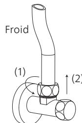
b. Faire glisser l'écrou du robinet à boisseau sphérique à trois voies sur le tuyau PE 3/8" et insérer le tuyau dans l'ouverture du robinet à boisseau sphérique à trois voies.
