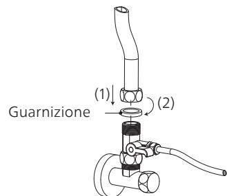
e. Spegnere la valvola a sfera a tre vie. Aprire l'afflusso di acqua fredda. Strofinare ed asciugare le connessioni con un panno per verificare l'eventuale presenza di perdite. Se il panno resta asciutto, vorrà dire che la valvola a sfera a tre vie è stata installata correttamente.
