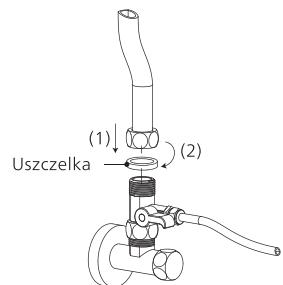
e. Zakręć trójdrożny zawór kulowy. Odkręć dopływ zimnej wody. Przetrzyj połączenia chusteczką, aby sprawdzić, czy nie ma wycieków. Jeśli chusteczka pozostaje sucha, oznacza to, że zawór trójdrożny jest zainstalowany prawidłowo.
