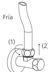
b. Deslice la tuerca de la válvula de bola de tres vías en la tubería de PE de 3/8" e inserte la tubería en la abertura de la válvula de bola de tres vías. Apriete la tuerca con una llave.
