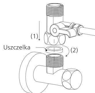
d. Połącz wąż zimnej wody z trójdrożnym zaworem kulowym i mocno przykręć go kluczem. Podczas instalacji nie zapomnij o uszczelce wewnętrz węża zimnej wody.
