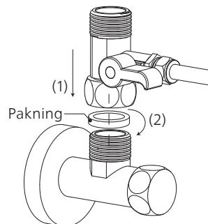
d. Forbind koldvandsslangen med trevejskugleventilen, og skru den fast med en skruenøgle. Vær opmærksom på pakningen i koldtvandsslangen under installationen.
