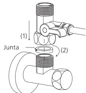
d. Conecte la manguera de agua fría con la válvula de bola de tres vías y atorníllela firmemente con una llave. No se olvide de la junta de la manguera de agua fría durante la instalación.
