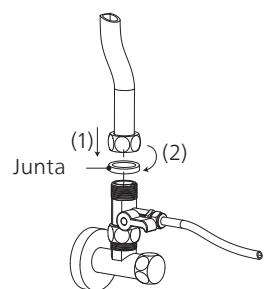
e. Cierre la válvula de bola de tres vías. Active el suministro de agua fría. Limpie las conexiones con un pañuelo de papel para ver si hay fugas. Si el pañuelo permanece seco, significa que la válvula de bola de tres vías está instalada correctamente.
