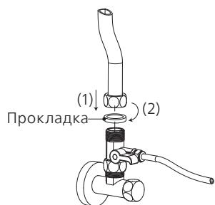
е. Выключите трехходовой шаровой кран. Включите подачу холодной воды. Протрите места соединения салфеткой, чтобы проверить, нет ли протечки. Если салфетка останется сухой, это значит, что трехходовой шаровой кран установлен правильно.
