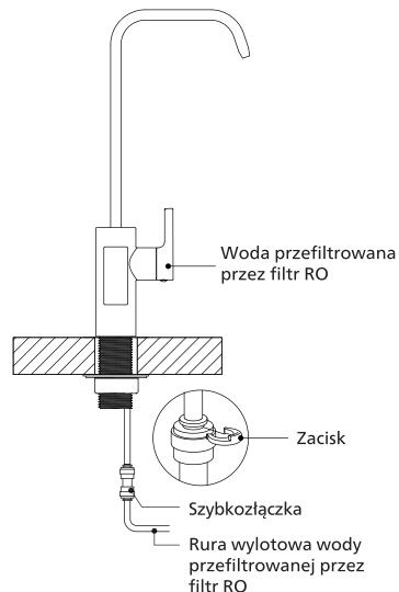
d. Łączenie wylotu wody odpływowej i złącza odpływowego. Zidentyfikuj miejsce wylotu wody odpływowej. Wywierć otwór 6,5 mm w rurze odpływowej. Zamocuj złącze odpływowe zgodnie ze schematem. Dokręć mocno nakrętki. Utnij fragment rury 1/4". Włóz do oporu jeden koniec rury do otworu wylotowego wody odpływowej z tyłu systemu. Użyj zacisku, aby zamocować rurę przy otworze. Włóz drugi koniec rury do złącza odpływowego.
