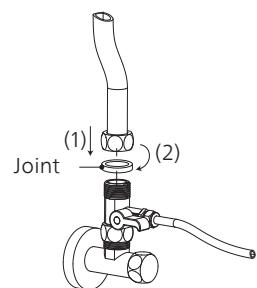
e. Fermer le robinet à boisseau sphérique à trois voies. Ouvrir l'alimentation en eau froide. Essuyer les raccords avec un mouchoir pour localiser la présence d'éventuelles fuites. Si le tissu reste sec, cela signifie que le robinet à boisseau sphérique à trois voies est installé de manière appropriée.
