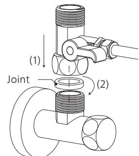
d. Connecter le tuyau d'eau froide au robinet à boisseau sphérique à trois voies et le visser fermement avec une clé. Ne pas oublier le joint situé à l'intérieur du tuyau d'eau froide au cours du montage.
